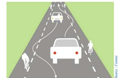
Principe de fonctionnement d'une CVCB
